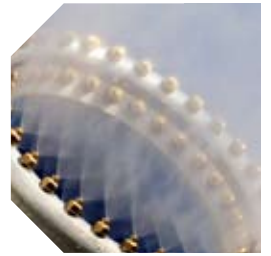
Detalle de la boca del cañón, mostrando las dos coronas de boquillas nebulizadoras en acción.
