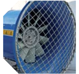
Detalle del ventilador instalado en el cañón del fog industrial Giraffa
