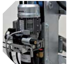
Detalle del grupo neumático del brazo hidráulico
