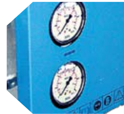
Detalle de los manómetros para el control de las presiones aire y agua.
